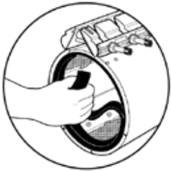
Käännä sisätivistet ulos suuremmalle putkelle
